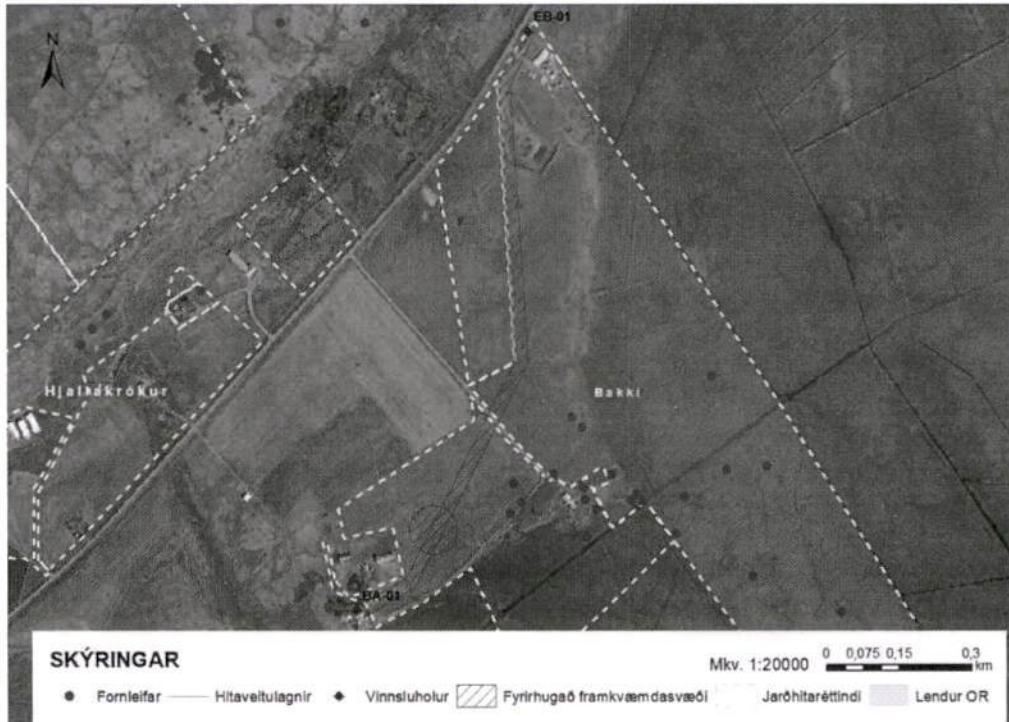
Mynd 1 Uppdrátturinn sýnir fyrirhugað framkvæmdasvæði afmarkað með rauðri skástrikun, ásamt núverandi vinnsluholum og hitaveitulögnum. Rauðir punktar sýna hnit aðalskráningar fornleifa á Bakka úr áfangaskýrslu III fyrir Aðalskráningu fornleifa í Ölfusi.
